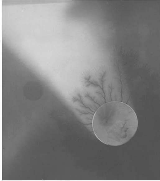
Σχήμα 1.2.3.5-3: Φωτογράφιση ενός εικοσάδραχμου κατά την επιφανειακή διάσπαση στον αέρα πολυμερών στερεών μονωτικών υπό κρουστική τάση 1,2/50μs (διάταξη ηλεκτροδίων ακίδα - πλάκα).
