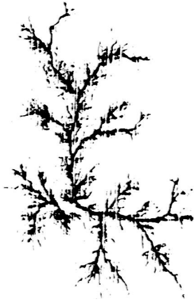
Σχήμα 1.2.3.5-3: Φωτογράφιση ενός εικοσάδραχμου κατά την επιφανειακή διάσπαση στον αέρα πολυμερών στερεών μονωτικών υπό κρουστική τάση 1,2/50μs (διάταξη ηλεκτροδίων ακίδα - πλάκα).
