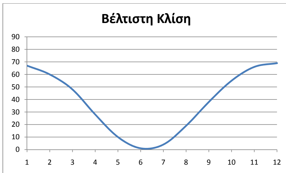
Σχήμα 4.63 :Βέλτιστη κλίση για κάθε μήνα του έτους για συλλέκτη με απόλυτα νότιο προσανατολισμό στην πόλη των Αθηνών
