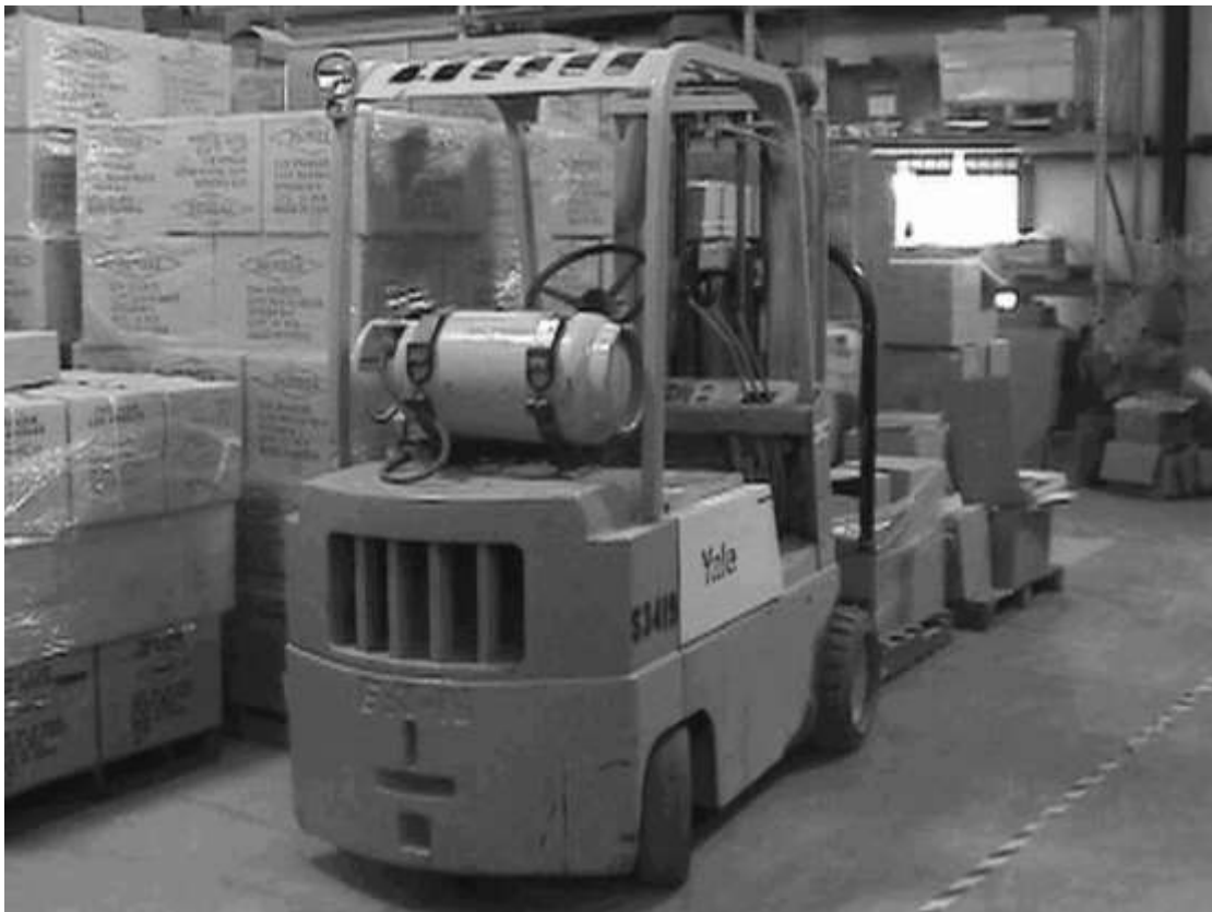
Εικόνα 1.11-8: Ανυψωτικό μηχάνημα. Αποτελεί κινούμενο εξοπλισμό που ευθύνεται για τη δημιουργία στατικού ηλεκτρισμού.
