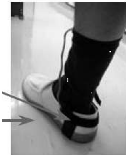
Εικόνα 1.11-5: Αντιστατικά παπούτσια με αγώγιμους μάντες(πάνω βέλος) σε αντιστατικό δάπεδο(κάτω βέλος) .
