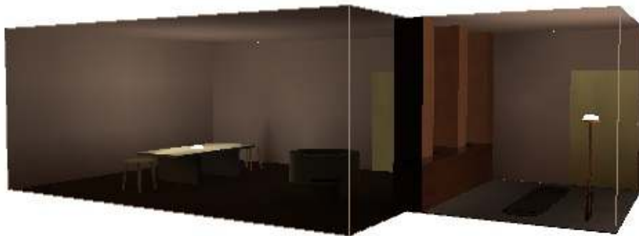
Εικόνα 5.19-Προσομοίωση φωτισμού χώρου d και e (προσομοίωση 1)
