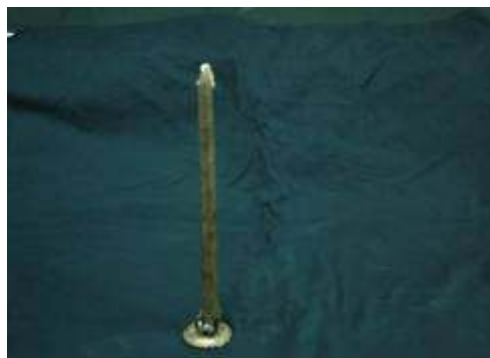
Εικόνα 4.35-Κερί με διάμετρο 1 Cm και φυτίλι βαμβακιού πάχους 3mm και ελεύθερου μήκους 1cm
