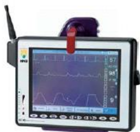
Εικόνα 26: Σύστημα μετάδοσης πληροφοριών ασθενοφόρου
