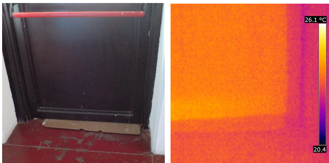
Σχήμα 5.20: Θερμογράφημα εξωτερικής θύρας
