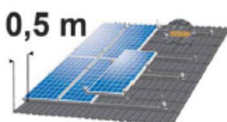
Σχήμα 2.2: Απόσταση Φ/Β από περίγραμμα στέγης
