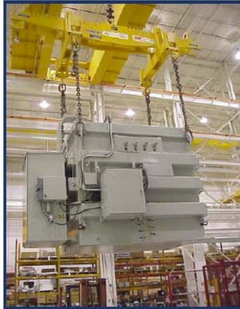
Σχήμα VI.2-3: Μετασχηματιστής υπεραγώγιμων υλικών ισχύος 5/10 MVA, [82].
