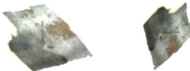
Εικόνα V.7-2: Επικαθίσεις θειούχου χαλκού σε χαρτί, [73] σχ.1g.
