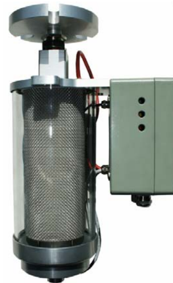
Σχήμα III.10-2: Αφυγραντής με αυτόματο σύστημα ξήρανσης. Ο κεντρικός κύλινδρος θερμαίνεται ξηραίνοντας το υγροσκοπικό υλικό, [62].
