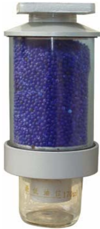
Σχήμα III.10-1: Αφυγραντής με υγροσκοπικό υλικό (silica gel). Το μπλε χρωμα υποδηλώνει ξηρότητα, [94].
