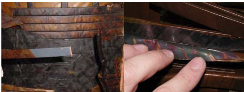
Εικόνα V.7-1: Επικαθίσεις θειούχου χαλκού σε αγωγούς, [73] σχ.1f.
