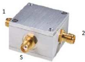
Εικόνα 15. Ο Combiner ZFSC-2-2500 της Mini Circuits που Χρησιμοποιήθηκε στο Πείραμα.
