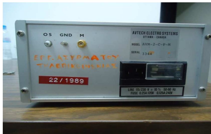
Εικόνα 6. Τροφοδοσία και επιπλέον επιλογές της γεννήτριας (OS – DC offset, Ground – γείωση και M δεύτερη έξοδος του σήματος της γεννήτριας εξασθενημένη κατά 20 dB).
