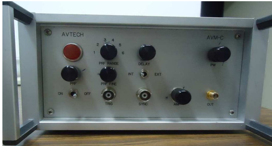
Εικόνα 5. Στην εικόνα φαίνονται οι επιλογές στην πρόσοψη της γεννήτριας. ON/OFF και ένδειξη λειτουργίας, τρεις κέρσορες για τη ρύθμιση του PRF (pulse repetition frequency), delay για ρύθμιση της σχετικής καθυστέρησης μεταξύ της αναφοράς του trigger και της κύριας εξόδου (η καθυστέρηση κυμαίνεται στην περιοχή 0-100nsec), είσοδος για εξωτερικό trigger (η επιλογή πρέπει να βρίσκεται στο EXT), synchronization – έξοδος του trigger, AM και PM (amplitude και pulse width)- ρύθμιση του πλάτους και της διάρκειας του παλμού εξόδου και τέλος OUT - έξοδος του παραγόμενου σήματος.
