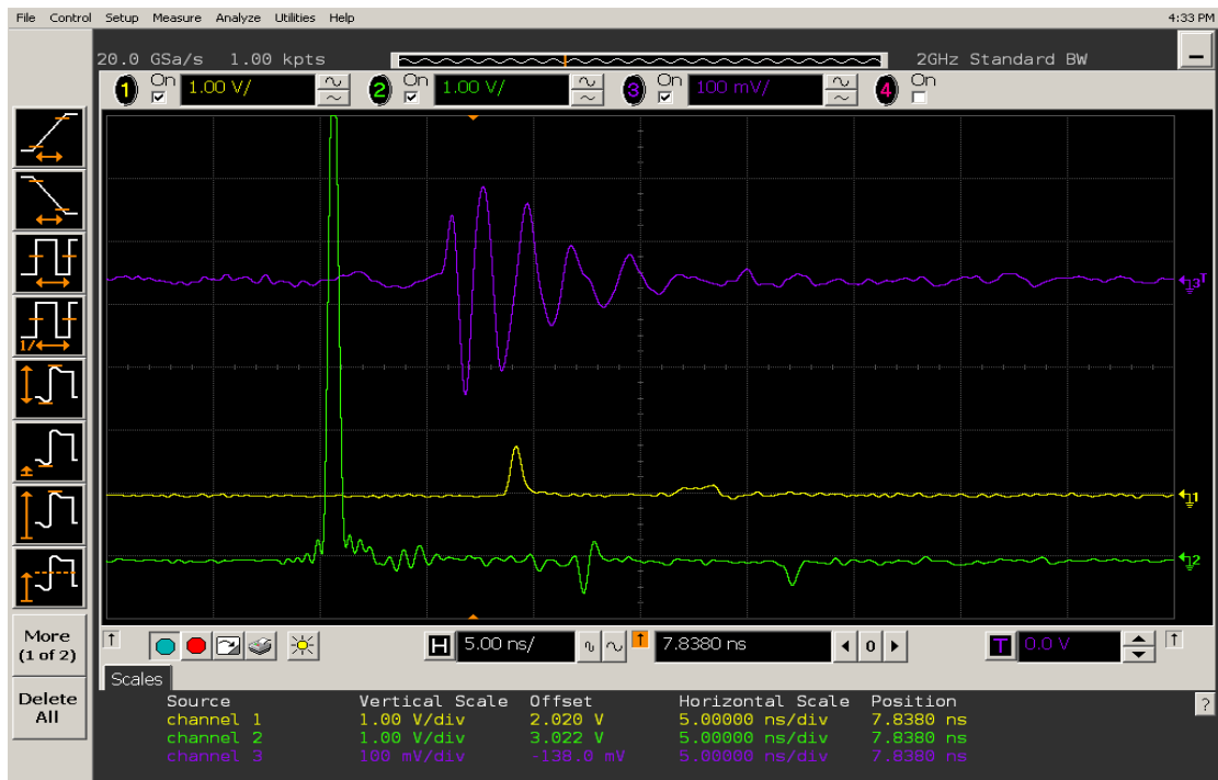
Σχήμα 43. Εξάλειψη των Ανακλάσεων από τους Εξασθηνητές.
