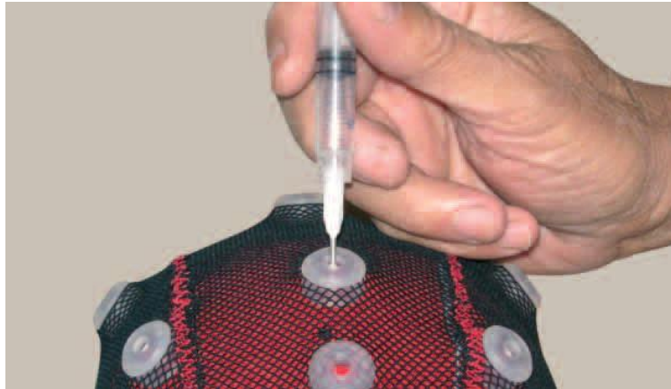
Εικόνα 1.12: Πλήρωση της κοιλότητας της γέλης του ηλεκτροδίου με τη χρήση σύριγγας [19].
