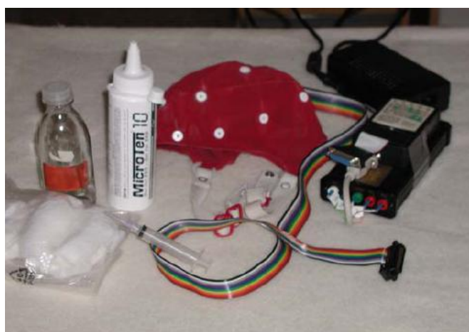
Εικόνα 1.11: Εξοπλισμός για τη λήψη του ΗΕΓ: μονάδα ενισχυτή, κάσκα ηλεκτροδίων, αγωγίμη γέλη, σύριγγα και υλικά για απολύμανση [21].
