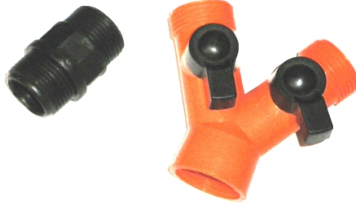
Εικόνα 4.5. Τα δύο κομμάτια που σχηματίζουν το σώμα του αισθητήρα.
