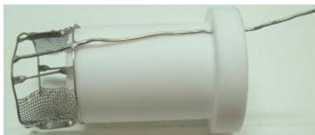
Εικόνα 6.3: Το βοηθητικό ηλεκτρόδιο από πλέγμα πλατίνας και η μονωτική βάση στήριξής του, από τεφλόν.
