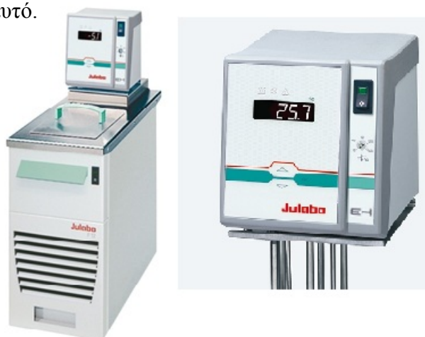
Εικόνα 6.5: Ο κυκλοφορητής, ο οποίος ρυθμίζει τη θερμοκρασία και σε λεπτομέρεια το ηλεκτρονικό θερμόμετρό του.
