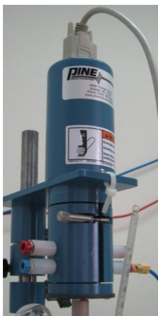
Εικόνα 6.6 : Ο ρότορας και οι υποδοχές των καλωδίων για τα ηλεκτρόδια εργασίας.
