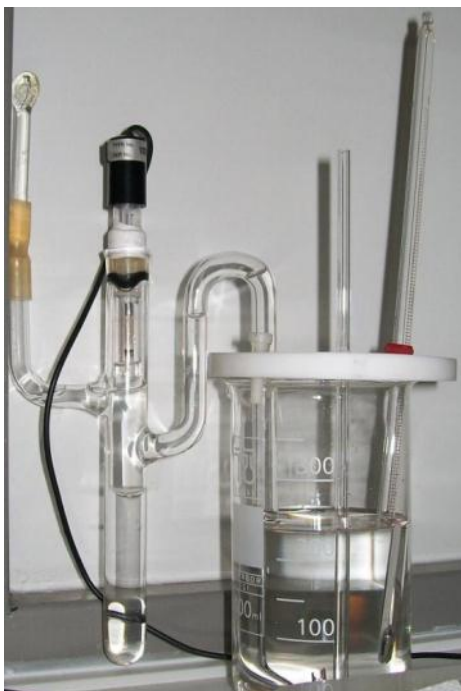
Εικόνα 6.1: Το ηλεκτρολυτικό κελί με το καπάκι από τεφλόν, στο οποίο στηρίζονται το υδραργυρικό θερμόμετρο, ο σωλήνας παροχής και το ηλεκτρόδιο αναφοράς.
