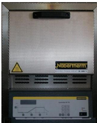
Εικόνα 6.14: Ο φούρνος που χρησιμοποιήθηκε για την θέρμανση του θερμοσυστελλόμενου καλύμματος, ο οποίος παρέχει τη δυνατότητα ρύθμισης μέγιστης θερμοκρασίας, του χρόνου ανόδου, του χρόνου διατήρησης της μέγιστης θερμοκρασίας και της χρονοκαθυστέρησης εκκίνησης της διαδικασίας.
