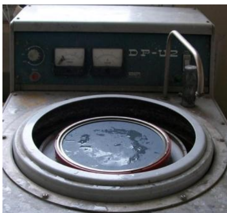
Εικόνα 6.13:Ο τροχός που χρησιμοποιήθηκε για τη λείανση των δοκιμίων.
