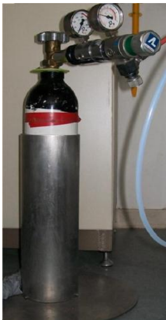
Εικόνα 6.16: Η φιάλη αζώτου, που χρησιμοποιήθηκε κατά την πειραματική διαδικασία. Στο εσωτερικό της φιάλης το άζωτο N_2 βρίσκεται υπό συνθήκες υψηλής πίεσης. Με το άνοιγμα της πρώτης βαλβίδας η πίεση ρυθμίζεται κοντά στην ατμοσφαιρική, ώστε να υπάρχει ροή και τέλος με το άνοιγμα της δεύτερης βαλβίδας το άζωτο ρέει προς το διάλυμά μας. Η ρύθμιση της ροής γίνεται μέσω της βαλβίδας που φαίνεται στο κάτω μέρος του μεταλλικού αγωγού.
