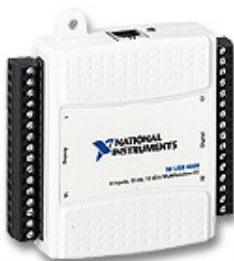
Σχήμα 5.3: Data acquisition USB 6009 που χρησιμοποιήθηκε για τη λήψη δεδομένων
