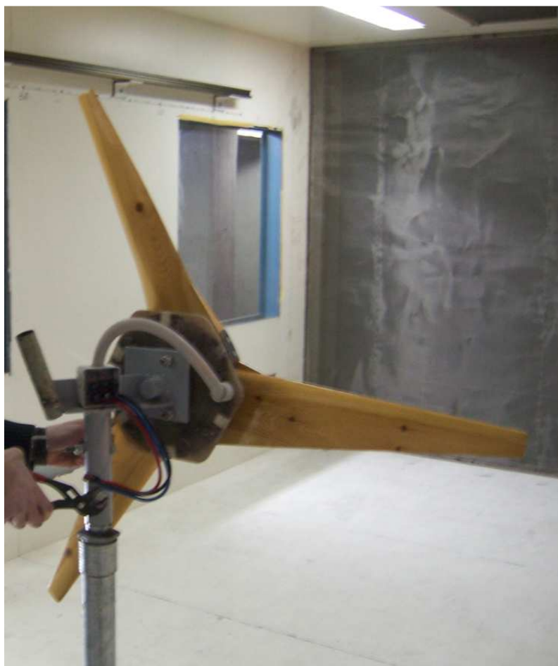
Εικόνα 7.3 : Τοποθέτηση της μικρής ανεμογεννήτριας σε ιστό στο εσωτερικό της αεροδυναμικής σήραγγας
