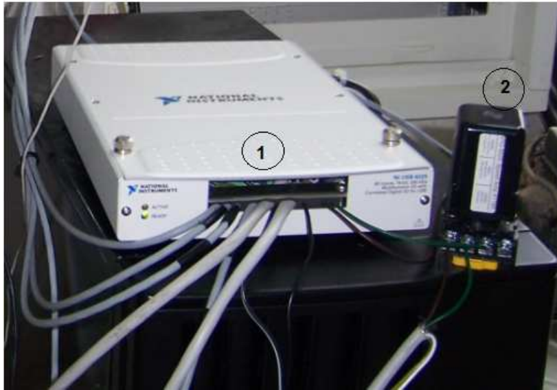
Εικόνα 8.3 : (1) Κάρτα καταγραφής σημάτων NI 6225 USB, (2) Μετατροπέας τετραγωνικού παλμού NRG #892E, ο οποίος συνδέεται με το ανεμόμετρο.
