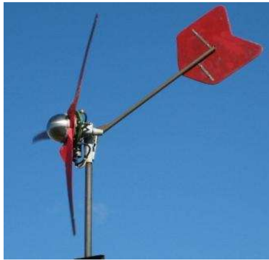
Εικόνα 4.1 : Ανύψωση της ουράς και επιβράδυνση της ταχύτητας περιστροφής μίας μικρής Α/Γ
