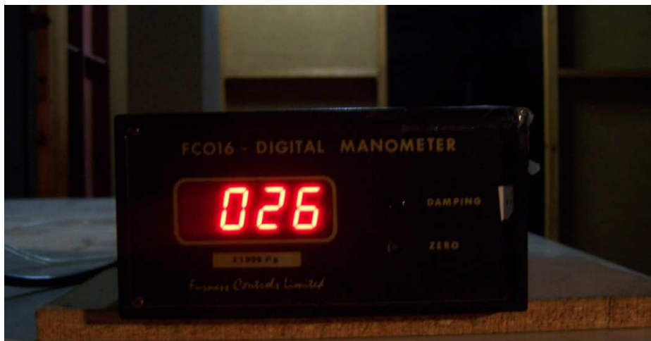
Εικόνα 7.2 : Ψηφιακό μανόμετρο για τη μέτρηση της πίεσης του ανέμου στην αεροσήραγγα
