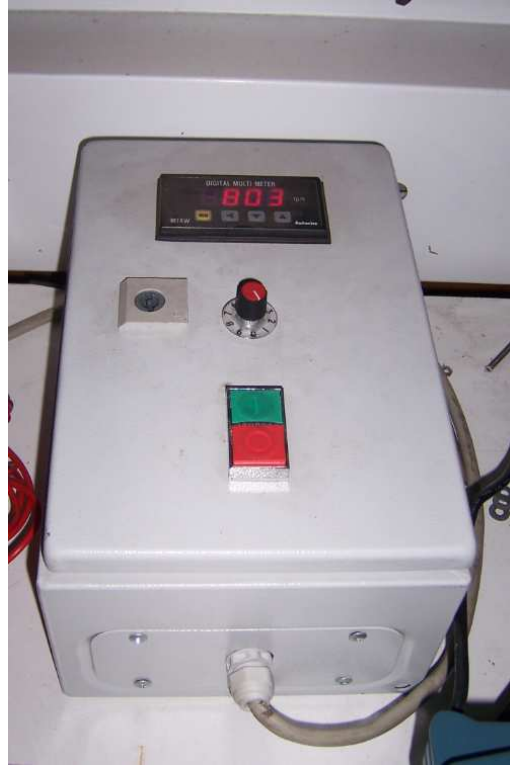
Εικόνα 7.1 : Σύστημα ελέγχου των στροφών του κινητήρα του στροβίλου παραγωγής ροής αέρα της αεροδυναμικής σήραγγας
