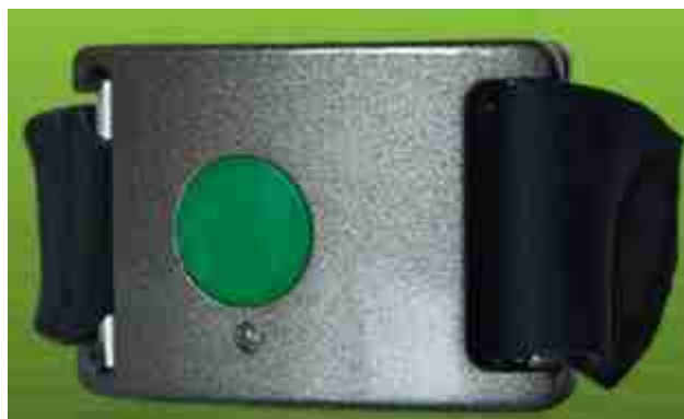
Εικόνα 3-22 Αισθητήρας αγωγιμότητας του δέρματος (Q Sensor)
