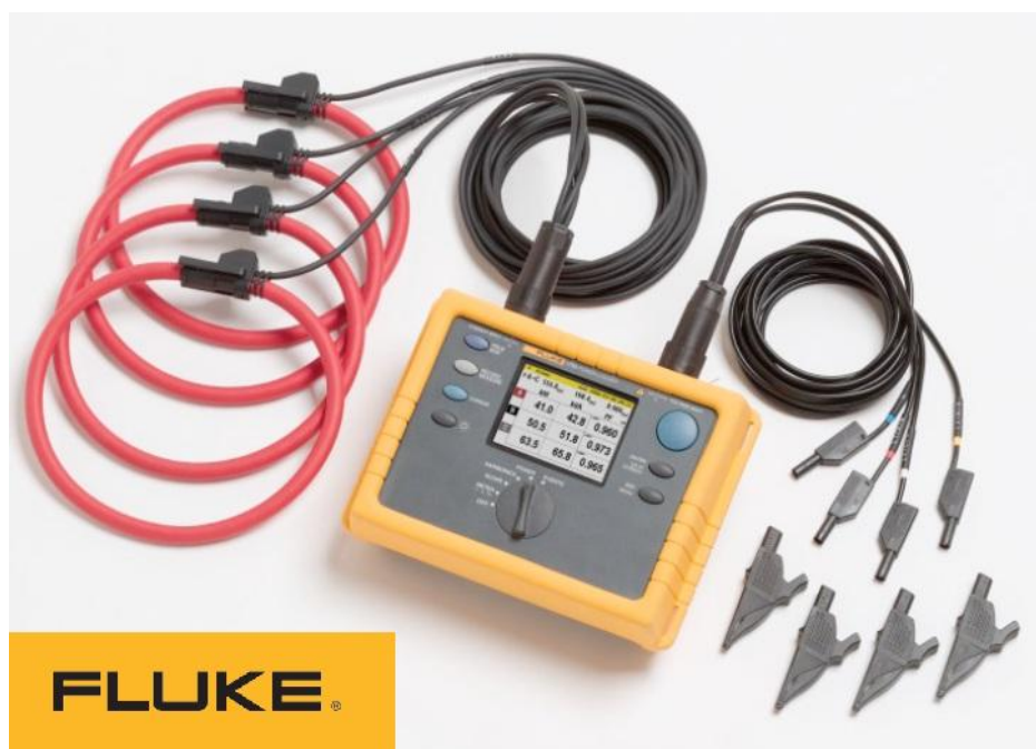
Εικόνα 5.31 Ο αναλυτής ενέργειας FLUKE 1735 που χρησιμοποιήθηκε για τη μελέτη ενός κλιματιστικού του Λαμπαδαρίου.
