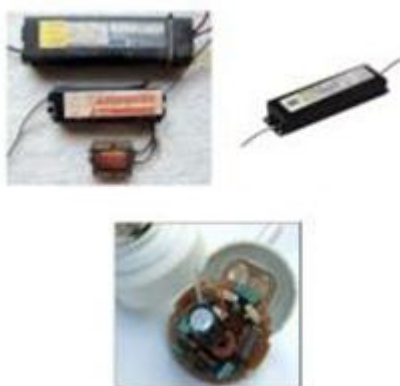
Εικόνα 6.6 Ηλεκτρομαγνητικά (πάνω) και ηλεκτρονικό (κάτω) ballast
