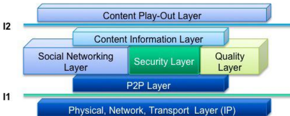
Εικόνα 29: Η στρωματοποιημένη προσέγγιση της peer to peer αρχιτεκτονικής του Saracen, με τον ορισμό των κύριων διαπαφών (L1 και L2) της αρχιτεκτονικής (Πηγή: [SARACEN3]).
