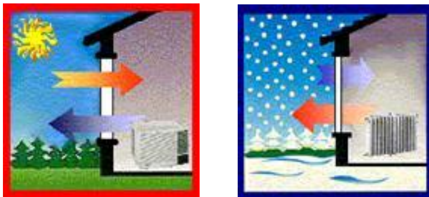
Σχήμα 2.2 Ανταλλαγή θερμότητας μέσω υαλοπινάκων [15]
