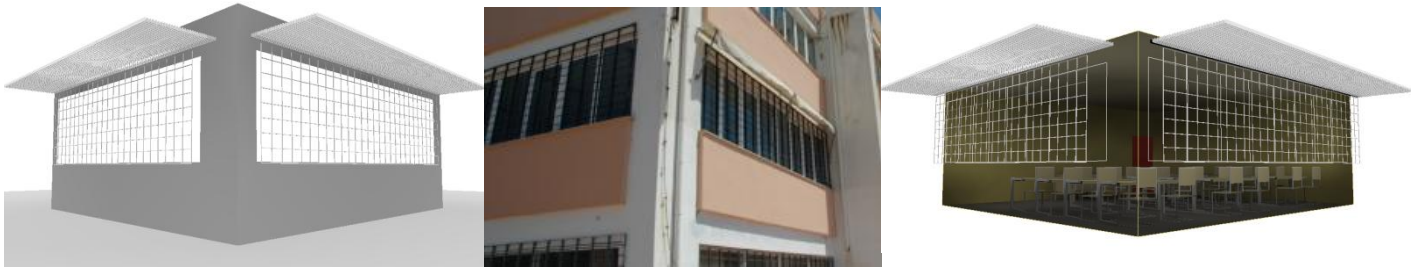
Εικόνα 8.3 Κατασκευή εξωτερικού μοντέλου για τον υπολογισμό του φυσικού φωτισμού
