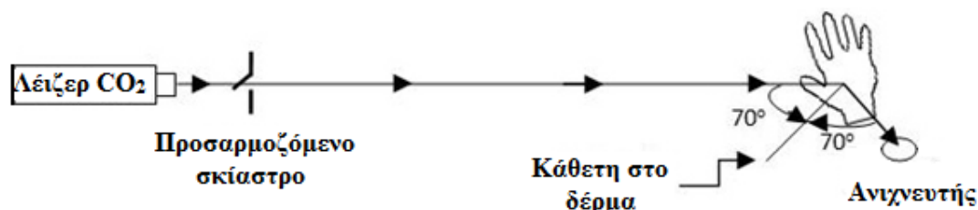
Εικόνα 4.2.2-1: Πειραματική διάταξη για την μέτρηση του δείκτη εκπομπής του δέρματος
