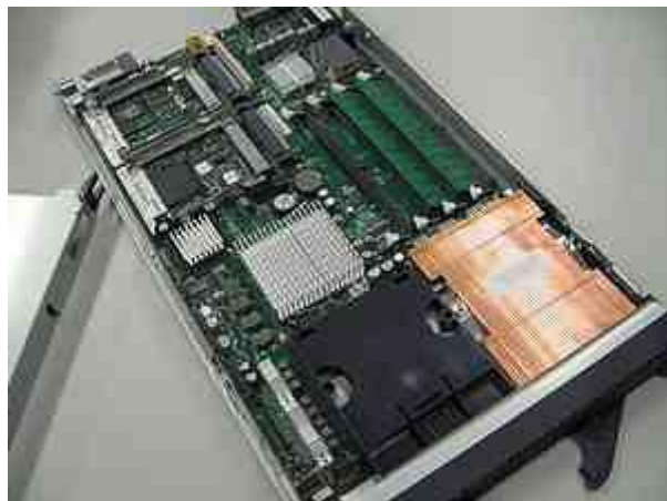
Εικόνα 3.3. Εξυπηρετητής blade HS20 της IBM
