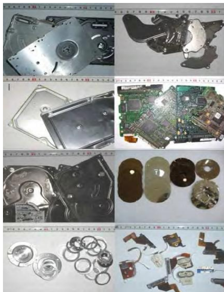
Εικόνα 3.2. Αποσυναρμολόγηση και Συλλογή Υλικών προς Αποκατάσταση
