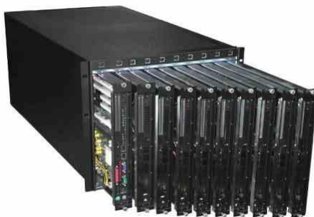
Εικόνα 3.4. Εξυπηρετητής blade και θήκη (“8U Rackmount Blade Server Chassis”)
