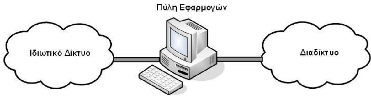
Σχήμα 4. 8 Τοποθέτηση μιας πύλης εφαρμογών μεταξύ ενός ιδιωτικού δικτύου και του διαδικτύου
