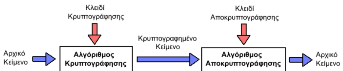
Σχήμα 4. 1 Ένα τυπικό σύστημα κρυπτογράφησης - αποκρυπτογράφησης.
