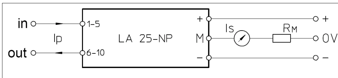
«Σχήμα A.5, το ισοδύναμο κύκλωμα του LEM μέτρησης ρεύματος LA 25-NP»
