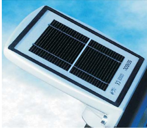
«Σχήμα 2.3, ο αισθητήρας της ακτινοβολίας (πυρανόμετρο) του ISET»
