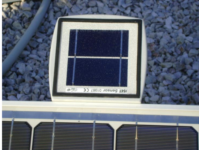
«Σχήμα A.9, το πυρανόμετρο του ISET που τοποθετήθηκε επί των Φ/Β πανέλων του εργαστηρίου ΣΗΕ»
