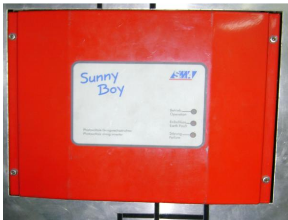
«Σχήμα 3.1, ο φωτοβολταϊκός αντιστροφέας Sunny Boy 1100 του εργαστηρίου ΣΗΕ»
