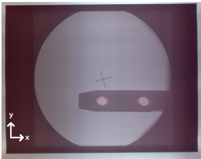
Σχήμα 5.28: Ακτινογραφικό στιγμιότυπο ήλου από C-arm με έμφαση στα περιγράμματα των δύο οπών του
