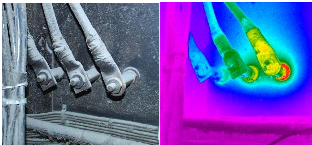
Εικόνα 1.16: Κανονική και θερμική φωτογραφία στατικών επαφών
