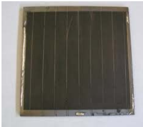
Εικόνα 10 : Φωτοβολταϊκό στοιχείο CdTe [ 18 ]
