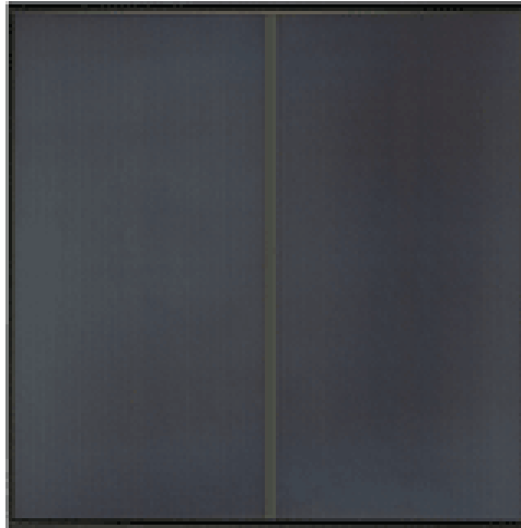
Εικόνα 9 : Φωτοβολταϊκό στοιχείο άμορφου πυριτίου [ 18 ]
