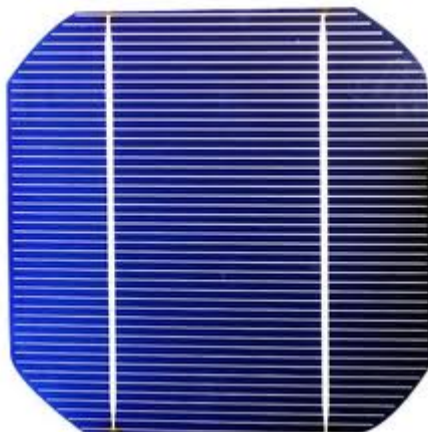
Εικόνα 5 : Φωτοβολταϊκό στοιχείο μονοκρυσταλλικού πυριτίου [ 18 ]
