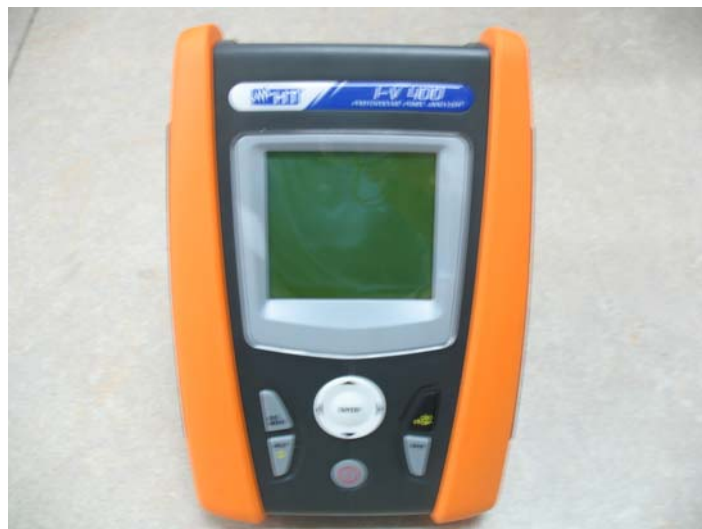
Εικόνα 17: Πολυόργανο μέτρησης HT SOLAR IV400
