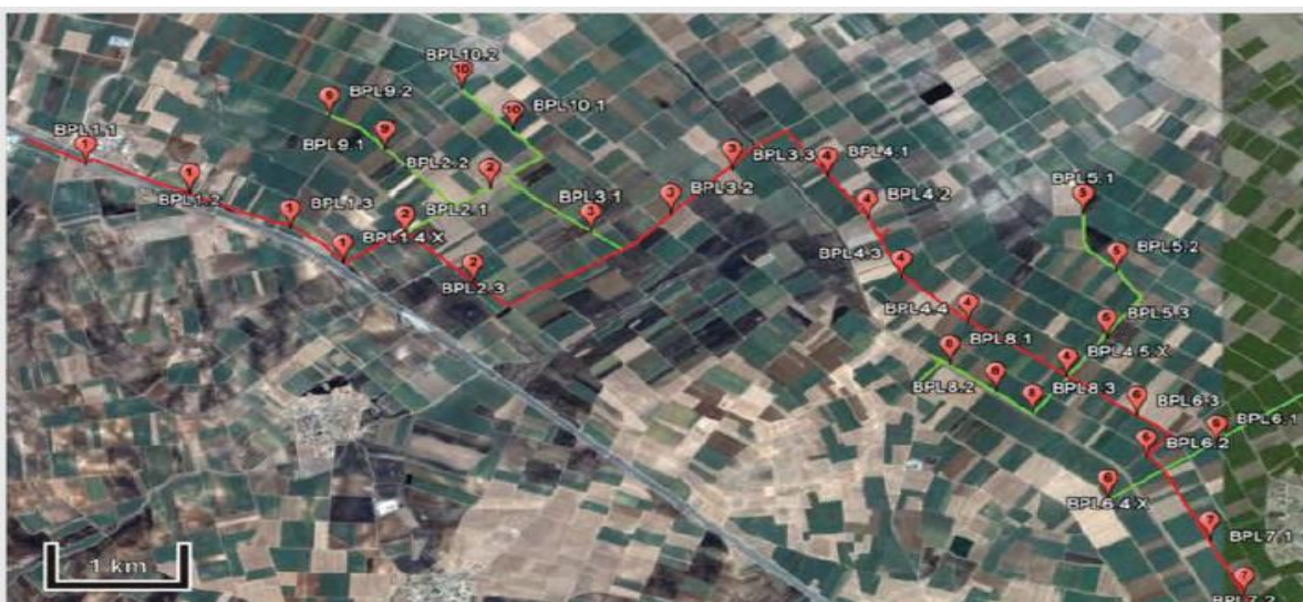
Εικόνα 1.11: Το υβριδικό ασύρματο- BPL δίκτυο που αναπτύχθηκε στη Λάρισα (Ελλάδα) από τη ΔΕΗ, BPL μονάδες στην πρώτη γραμμή MT
