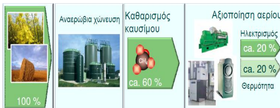
Σχήμα 2.14: Παραγωγή αερίου από αναερόβια χώνευση βιομάζας [28]
