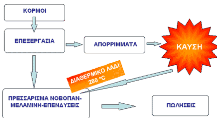
Σχήμα 2.17: Διάγραμμα ροής παραγωγικής διαδικασίας επεξεργασίας ξυλείας [23]
