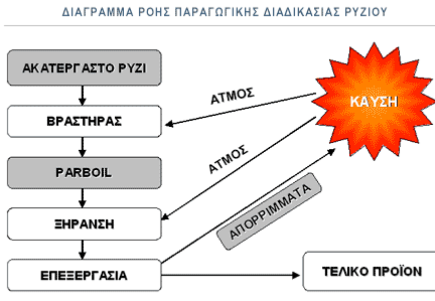
Σχήμα 2.18: Διάγραμμα ροής παραγωγικής διαδικασίας ρυζιού [23]
