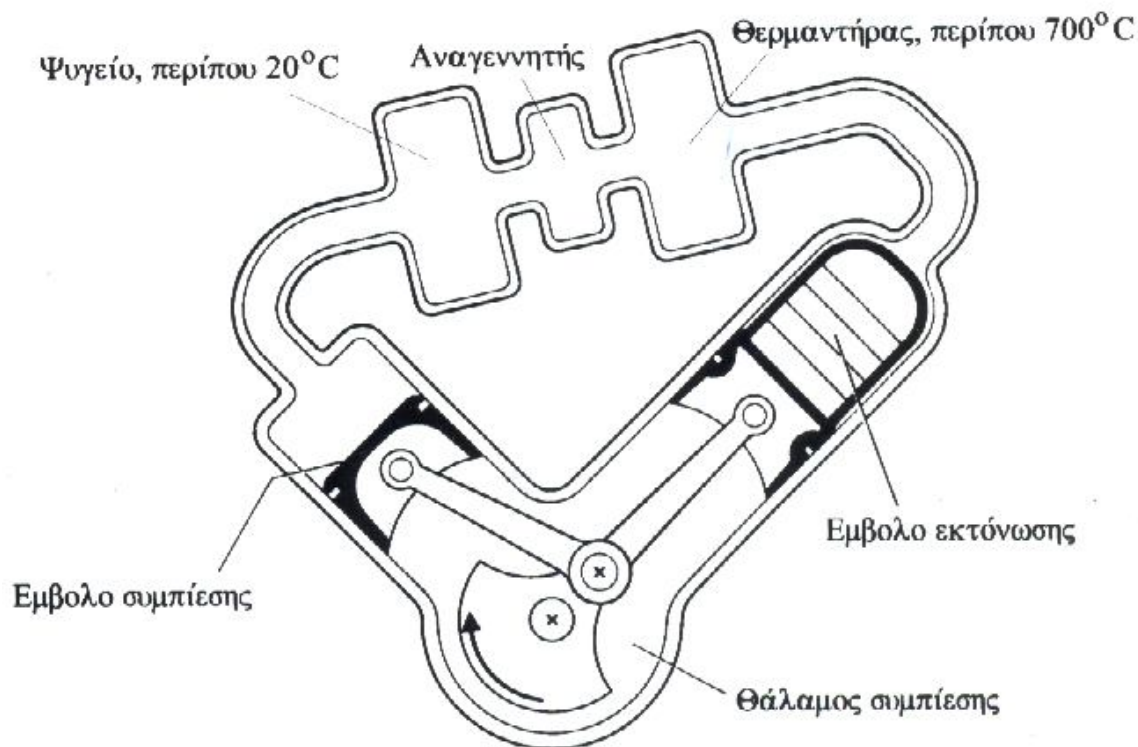
Σχήμα 1.16: Απλοποιημένη απεικόνιση κινητήρα Stirling [2]
