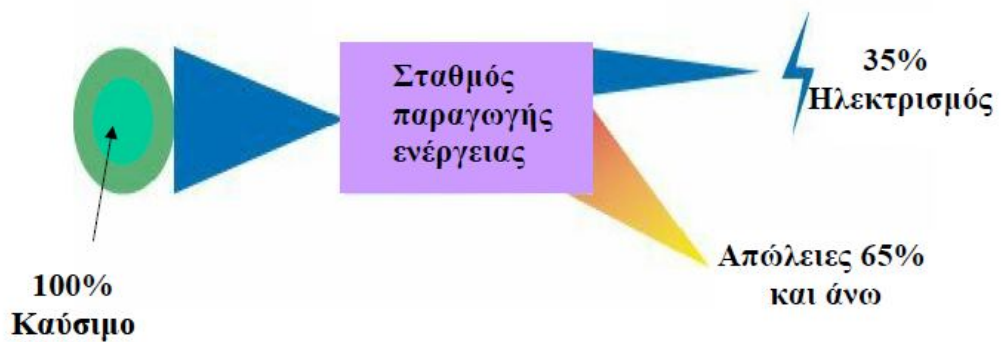
Σχήμα 1.1: Συμβατικό σύστημα παραγωγής ενέργειας [2]
