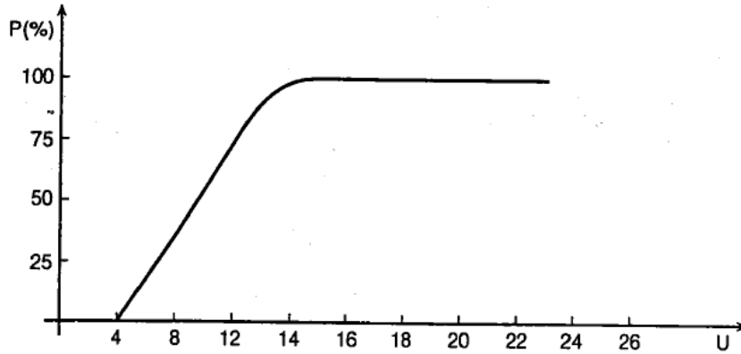
Εικόνα Δ.2.3. Τυπική καμπύλη ισχύος- ταχύτητας ανέμου για ανεμογεννήτρια με έλεγχο βήματος έλικας.
