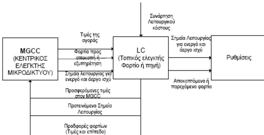
Εικόνα Γ.2.4. Η ροή πληροφορίας μεταξύ του κεντρικού ελέγκτη και των τοπικών ελεγκτών σε ένα μικροδίκτυο.
