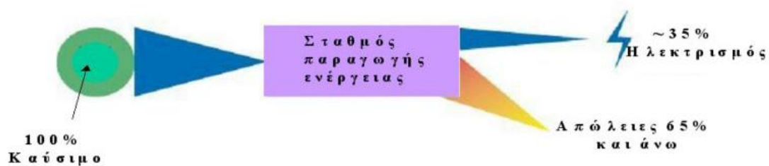
Σχήμα 1.1(α). Συμβατικό σύστημα παραγωγής ηλεκτρικής ενέργειας
