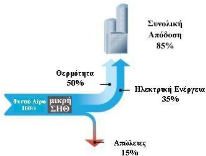
Σχήμα 1.1(γ).Βαθμός απόδοσης μονάδας ΣΗΘ
