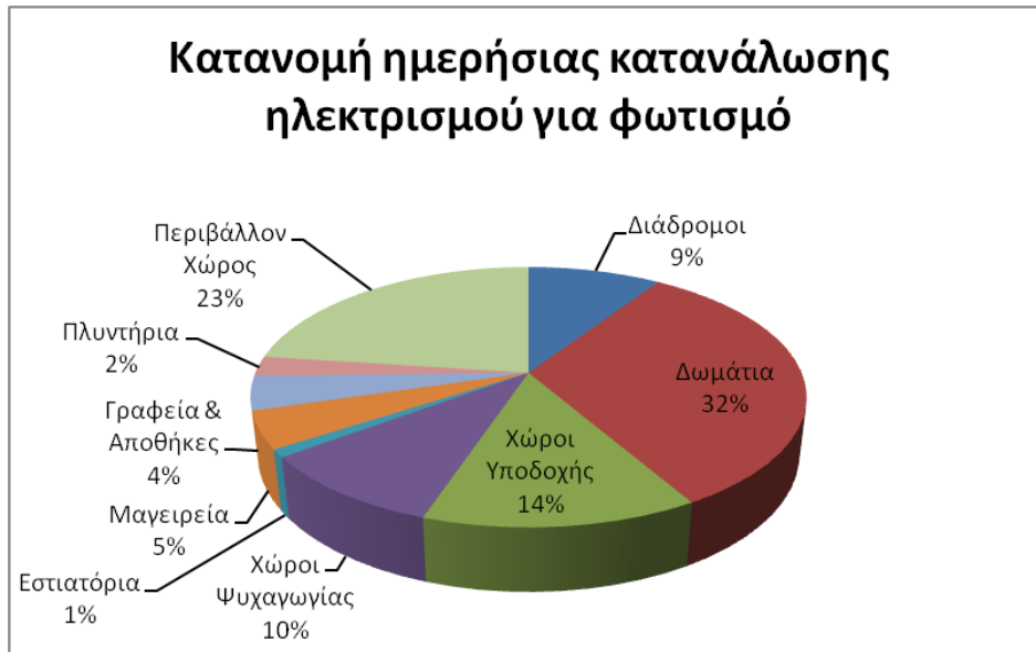
Σχήμα 4.3 Κατανομή κατανάλωσης ηλεκτρισμού για φωτισμό
