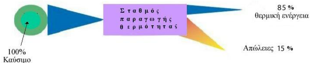
Σχήμα 1.1(β). Συμβατικό σύστημα παραγωγής θερμικής ενέργειας
