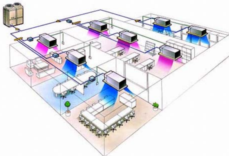
Εικόνα 5.1: Εγκατάσταση συστήματος VRV σε κτίριο
