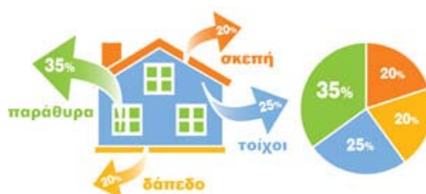
Εικόνα 5.4: Θερμικές απώλειες κτιριακού κελύφους
