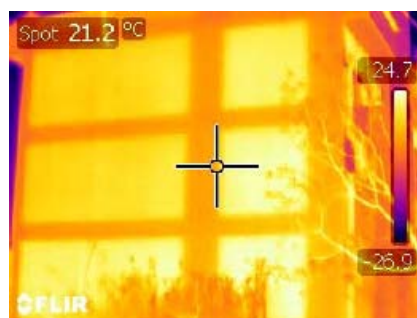
Εικόνα 2.3: Θερμογέφυρες σε σημεία ένωσης διαφορετικών υλικών
