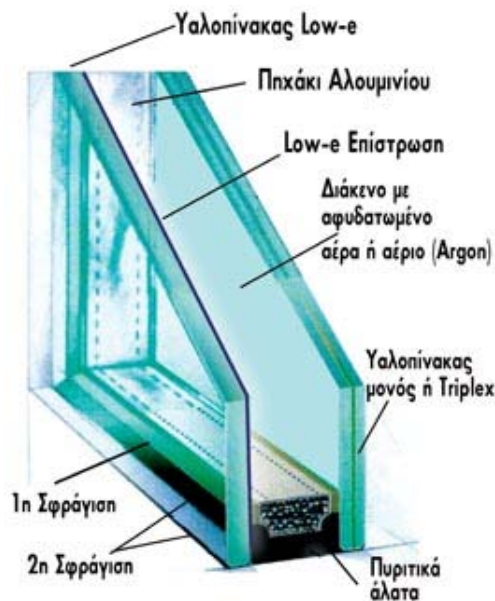
Εικόνα 5.5: Δομή ενεργειακού υαλοπίνακα
