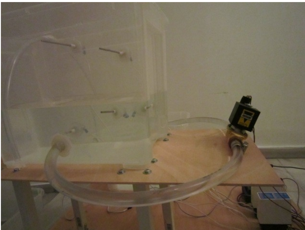
Εικ. 2.5 : Σωλήνωση ηλεκτροβαλβίδας
