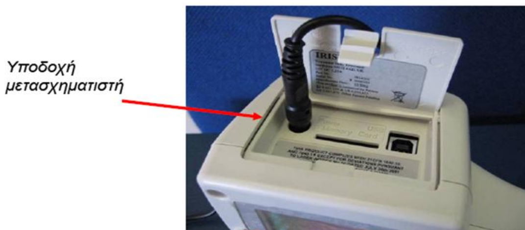
Εικόνα 4.2 Διακρίνεται η θύρα υποδοχής της κάρτας μνήμης και η θύρα USB
