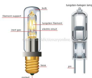
Εικόνα 1-8: Πηγές πυρακτωμένου φωτός – λαμπτήρες με νήμα βολφραμίου (incandescent light sources)
