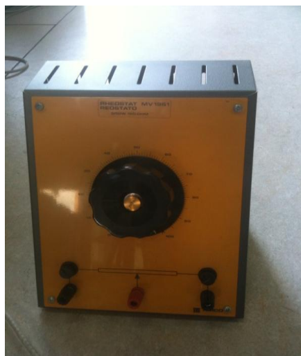
Σχήμα 4.7. Μεταβλητή αντίσταση 500W ισχύς και 150\Omega συνολική αντίσταση
