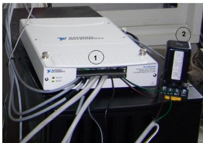
Σχήμα 3.3 Κάρτα καταγραφής σημάτων (1) NI 6225 USB, (2) Μετατροπέας τετραγωνικού παλμού που συνδέεται με το ανεμόμετρο για την ανεμογεννήτρια
