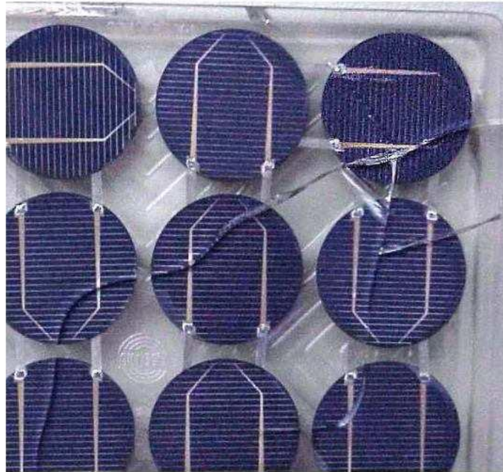
Σχήμα 4.21. Σπασμένο πλαίσιο μονοκρυσταλλικού πυριτίου λόγω υπερθέρμανσης
