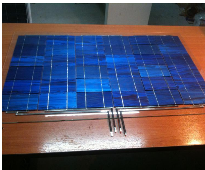
Σχήμα 4.1. Μπροστά όψη του φ/β πλαισίου τοποθετημένο πάνω σε γυαλί
