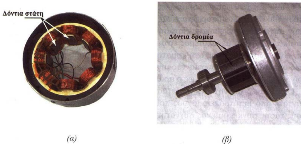
Σχήμα 2.35 Μηχανή μαγνητικής αντίστασης διακοπτικής διέγερσης 4-φασική, 8/6: (α) στάτης (β) δρομέας
