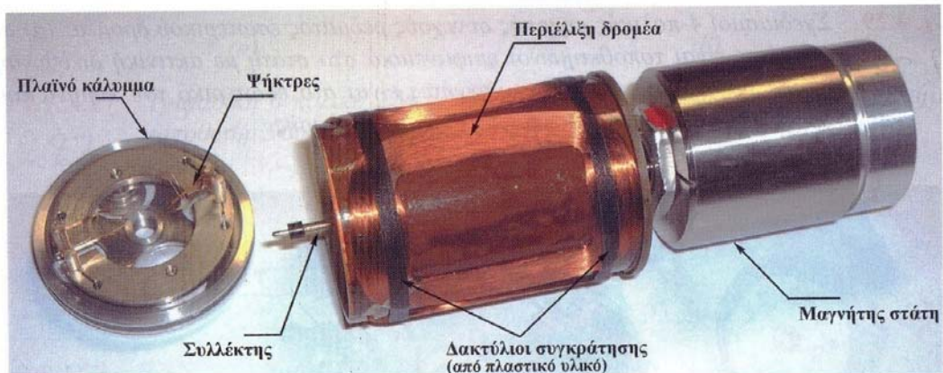
Σχήμα 2.31 Μηχανή συνεχούς ρεύματος μόνιμου μαγνήτη (κυλινδρικού σχήματος) εξωτερικού δρομέα χωρίς πυρήνα με συγκεντρωμένα τυλίγματα
