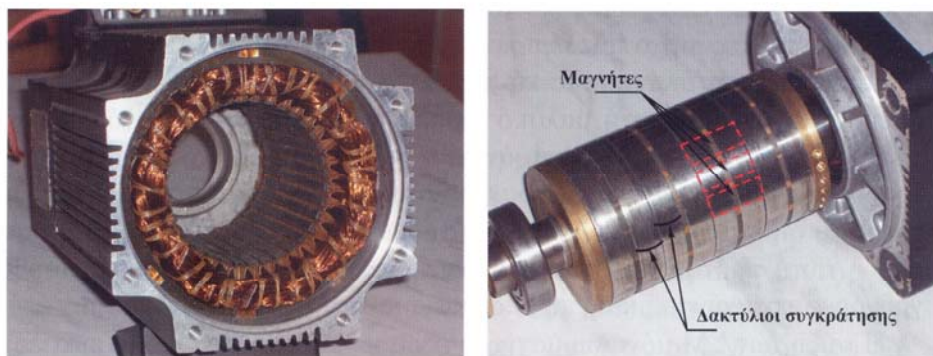
Σχήμα 2.3 Τριφασική 8-πολική ΣΜ εσωτερικού δρομέα με μαγνήτες επιφανειακής θέσης: (α) στάτης και (β) δρομέας
