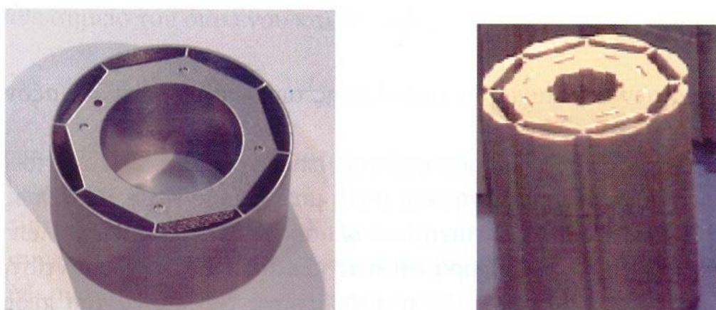
Σχήμα 4.26 Πυρήνες δρομέα 8-πολικών ΣΜ όπου οι μαγνήτες τοποθετούνται εσωτερικά στον πυρήνα, με ακτινική διεύθυνση των μαγνητικών τους αξόνων
