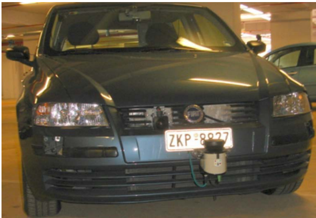
Εικόνα 3.1: Πειραματικό αυτοκίνητο με το λέιζερ LMS151
