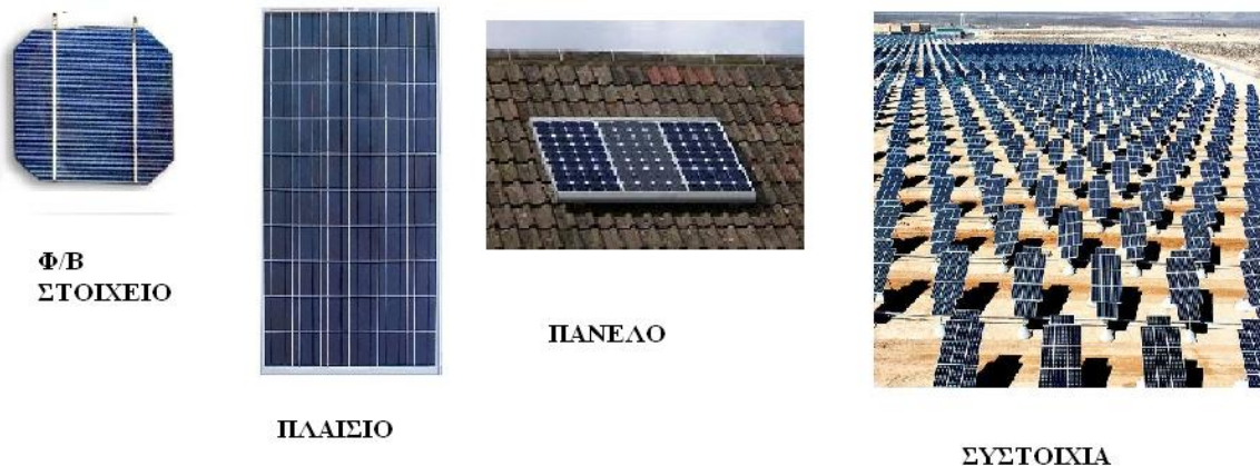
Εικόνα 1.2 Η σύνθεση των φωτοβολταϊκών συλλεκτών
