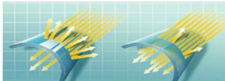
Σχήμα 2.5 Σωλήνας από βοριοπυριτικό γυαλί χωρίς αντι-ανακλαστική επίστρωση (αριστερά) και με αντι-ανακλαστική επίστρωση (δεξιά)
