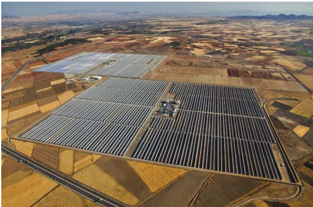
Σχήμα 2.7 Οι ηλιοθερμικοί σταθμοί παραβολικών κατόπτρων Andasol 1 (μπροστά) και Andasol 2 (πίσω) στην Ισπανία. Ο σταθμός παραγωγής ισχύος και το σύστημα αποθήκευσης θερμότητας βρίσκονται στο κέντρο καθενός ηλιακού πεδίου [26]
