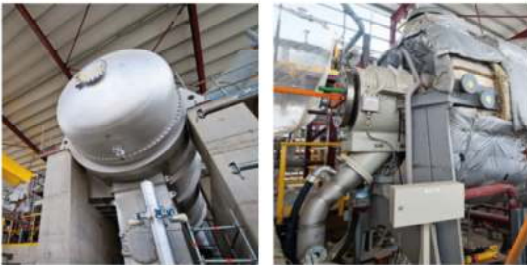
Σχήμα 3.15 Ο εμπορικά επιτυχημένος ατμοστρόβιλος SST-600 της Siemens, ιδανικός για ηλιοθερμικούς σταθμούς ηλεκτροπαραγωγής. [86]
