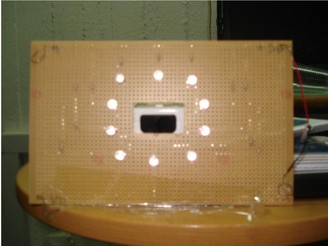
Εικόνα 22: Πλακέτα με led υπερόθρου (ir led array) και προσαρμοσμένη κάμερα wii remote στο κέντρο της.
