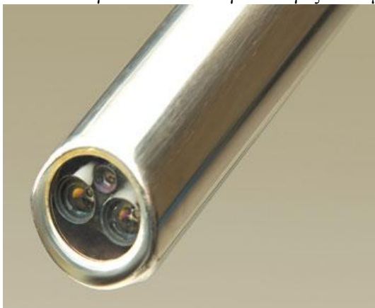
Εικόνα 4: Ενδοσκόπιο 3-D που χρησιμοποιείται στο σύστημα Da Vinci (διαθέτει δύο κάμερες για τρισδιάστατη απεικόνιση
