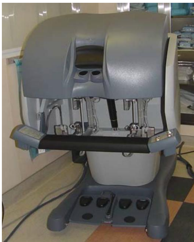
Εικόνα 5: Η κονσόλα του χειρουργού που περιλαμβάνει ένα διοπτρικό σύστημα οθονών για τρισδιάστατη απεικόνιση (InSite Vision System)
