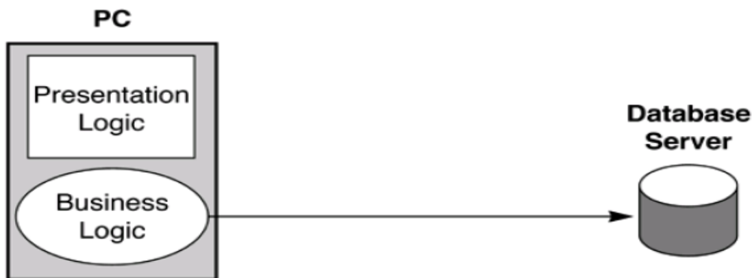
Εικόνα 9: Αρχιτεκτονική δικτυακής εφαρμογής 2 στρωμάτων (client - server)
