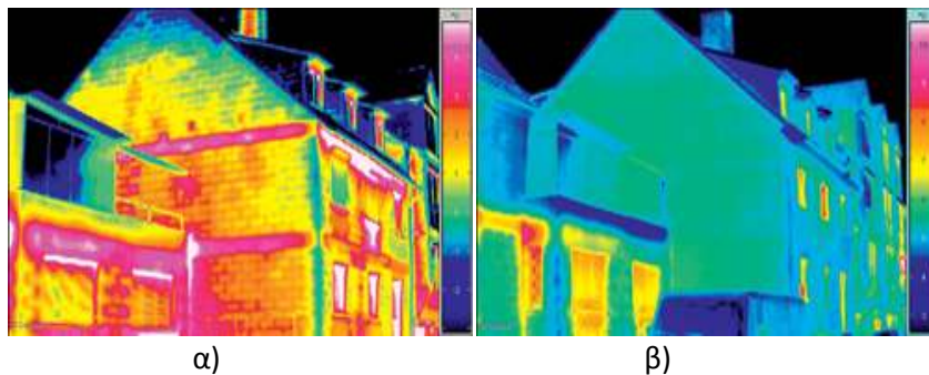
Εικόνα 1.1 : Θερμικές απώλειες α) χωρίς και β) με εξωτερική θερμομόνωση
