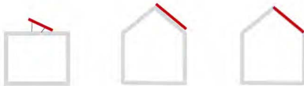
Σχήμα 2.2: Τρόποι ενσωμάτωσης φωτοβολταϊκών πλαισίων σε στέγη. [2]
