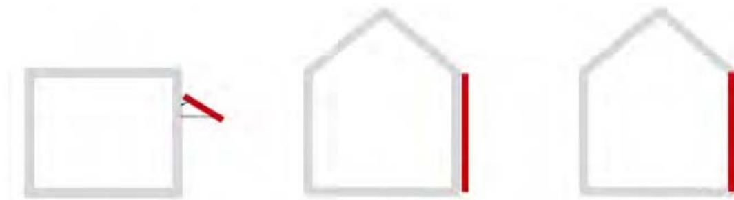
Σχήμα 2.3: Τρόποι ενσωμάτωσης φωτοβολταϊκών σε πρόσοψη κτιρίου[5]
