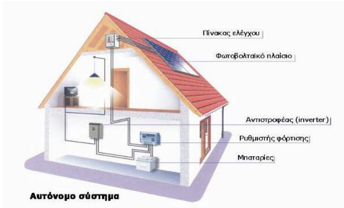
Σχήμα 6.2: Αυτόνομο Φωτοβολταϊκό Σύστημα
