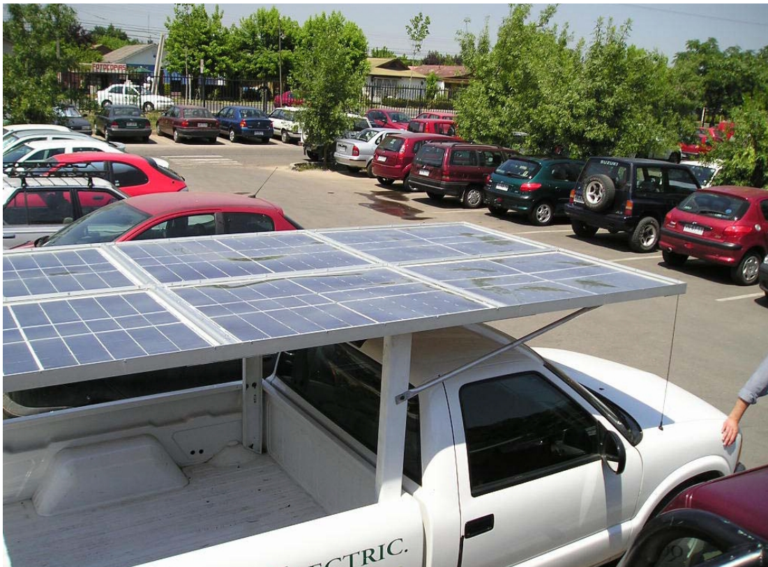
Εικόνα 38: EV με 6 φωτοβολταϊκά πάνελ εγκαταστημένα στην οροφή
