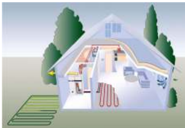
Εικόνα 5.2-16: Αντλία θερμότητας με πηγή θερμότητας το έδαφος.
