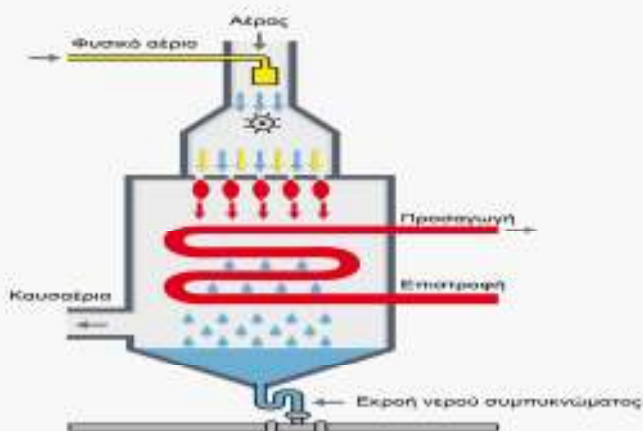
Εικόνα 5.2-10: Λειτουργία συστήματος συμπύκνωσης. [36]
