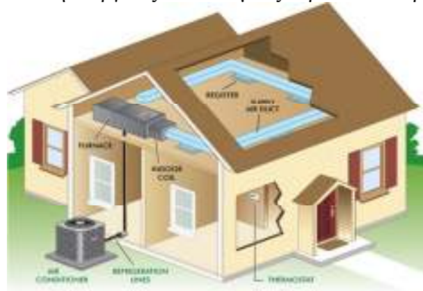
Εικόνα 5.2-17: Σύστημα HVAC κατοικίας.
