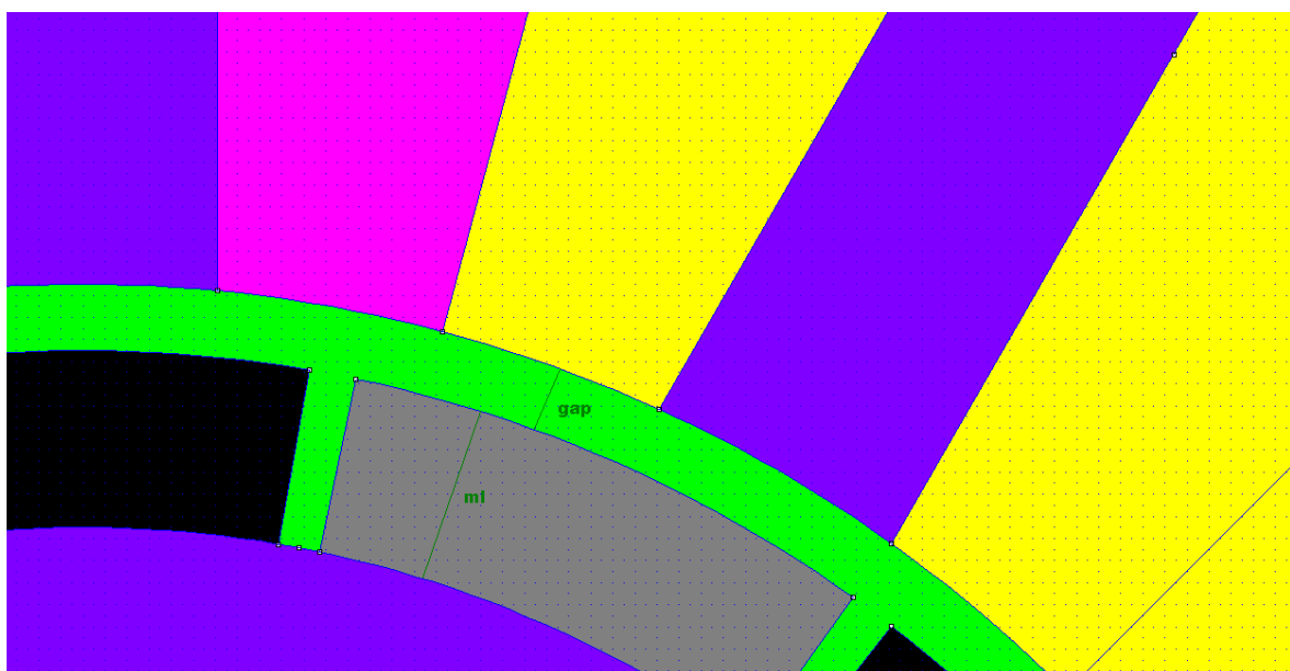
Σχήμα 3.8: Κύριες μεταβλητές παραμετροποιημένου σχεδιασμού (συνέχεια): ακτινικό μήκος μαγνήτη και διάκενο.
