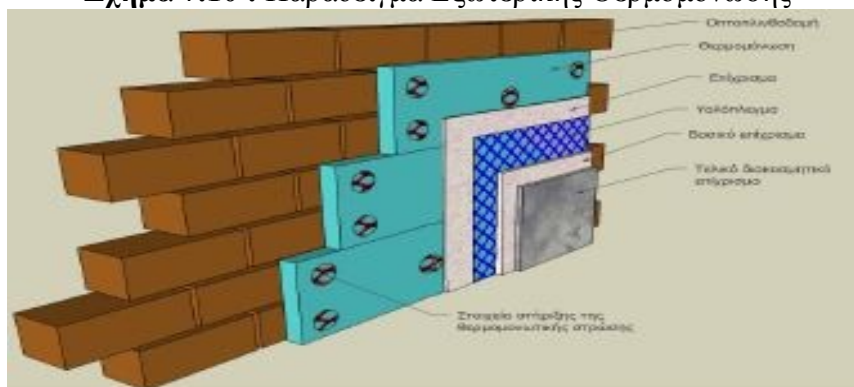
Σχήμα 7.10 : Παράδειγμα Εξωτερικής Θερμομόνωσης
