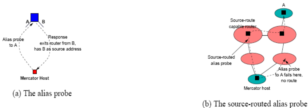
Εικόνα 1.4 ♦ (a) Η αποστολή alias probe στη διεπαφή A του δρομολογητή, οδηγεί στην εύρεση της διεπαφής B που ανήκει στον ίδιο δρομολογητή. (b) Παράδειγμα alias probe με δρομολόγηση πηγής. Ο δρομολογητής δεξιά του κόμβου πηγής (Mercator) δεν προωθεί το alias probe στο δρομολογητή A . Η ύπαρξη του δρομολογητή με δυνατότητα δρομολόγησης πηγής διορθώνει αυτό το πρόβλημα.
