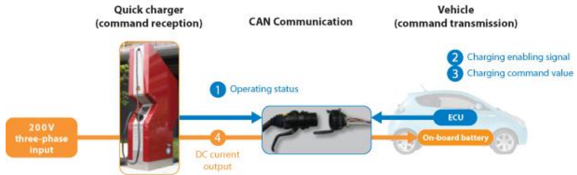
Εικόνα 1.22 : Αναπαράσταση ταχείας φόρτισης με φορτιστή τύπου CHAdeMO [1.29]
