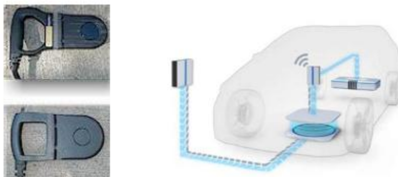
Εικόνα 1.17 : Υποδοχέας και Λειτουργία Επαγωγικού Φορτιστή [1.14]
