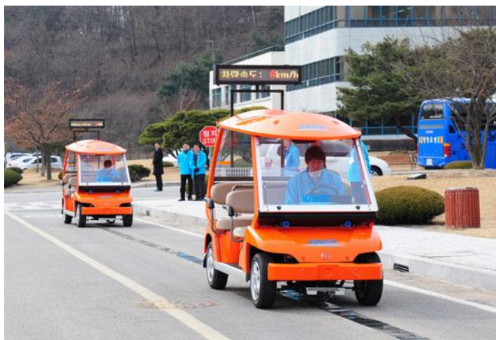
Εικόνα 1.19 : Όχημα με σύστημα OLEV που αναπτύχθηκε από το KAIST [1.17]
