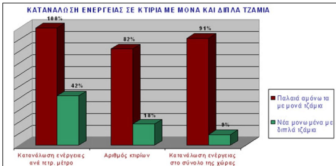
Σχήμα 3.6: Κατανάλωση ενέργειας σε κτίρια με παλαιούς, αμόνωτους, μονούς υαλοπίνακες και σε κτίρια με νέους, μονωμένους, διπλούς υαλοπίνακες.
