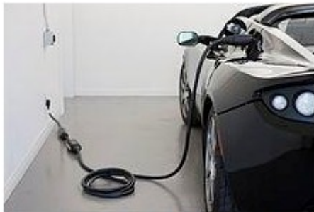
Σχήμα 5.11 Ένα Tesla Roadster φορτίζει με παροχή 70A, 240V
