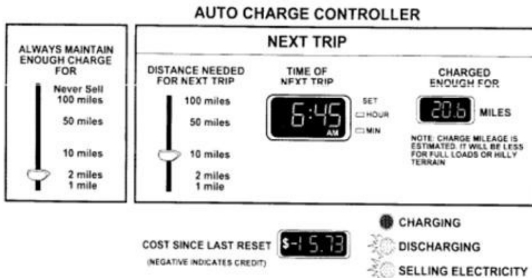
Σχήμα 5.9 Σχηματική απεικόνιση ενός έξυπνου μετρητή για V2G concept
