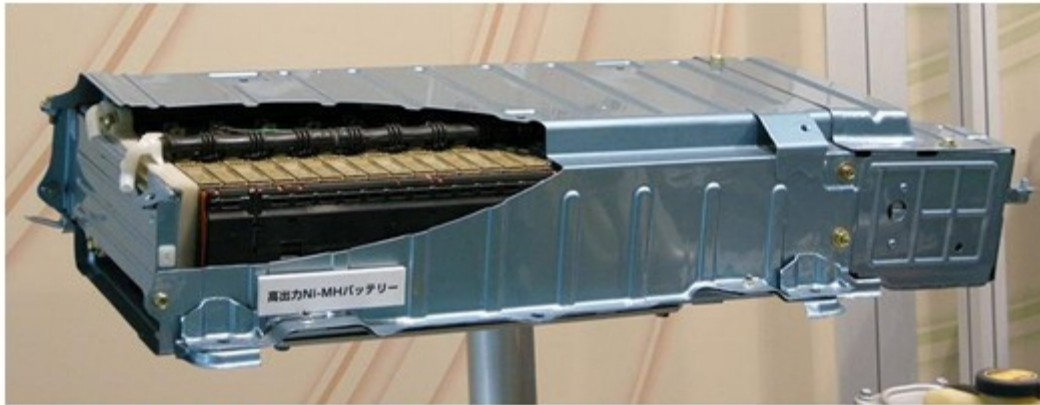
Σχήμα 5.14 Μία συστοιχία μπαταριών από το Toyota Prius
