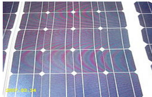
Φωτοβολταϊκά από μονοκρυσταλλικό πυρίτιο
